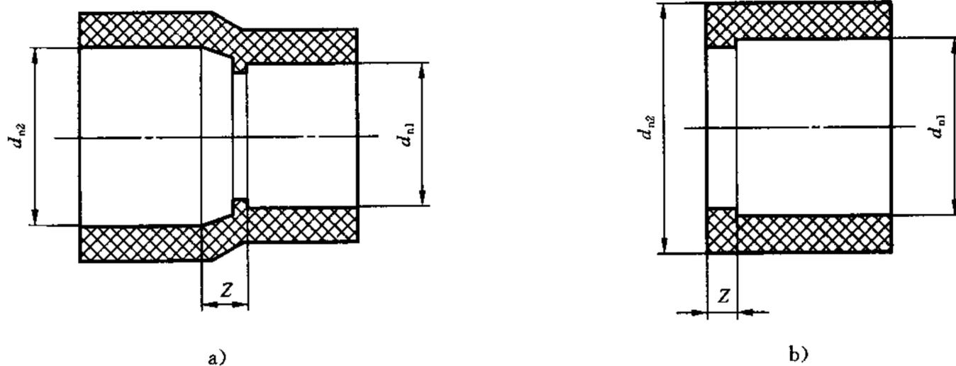
图 A.2 变径接头
