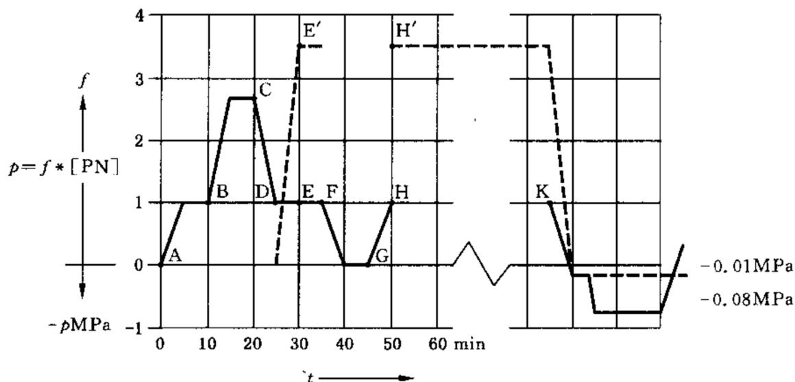
图 B.9 有弯曲力的静液压实验图表
