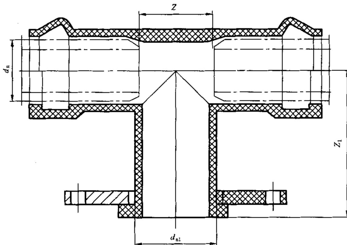
图 A.6 法兰支管双承口接头三通
