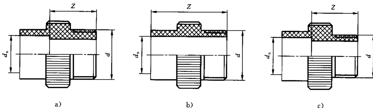
图 A.13 粘接和外螺纹变接头
