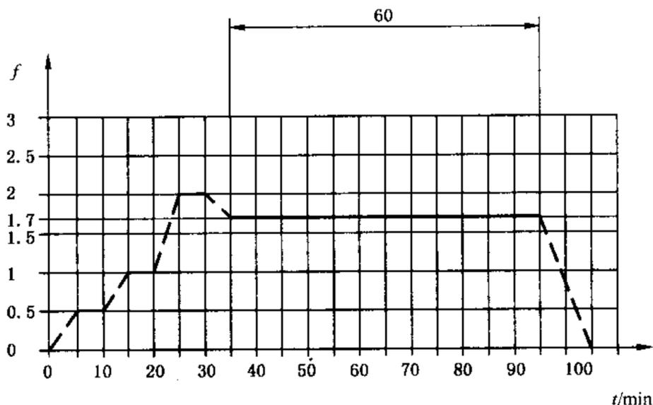
图 4 内压和角向挠度试验
