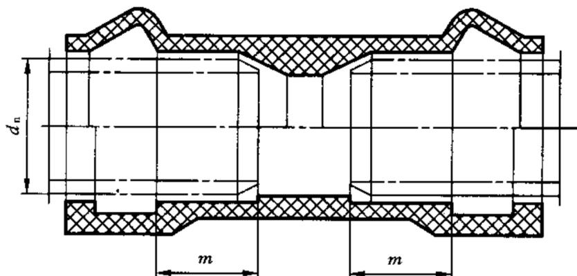
图 2 弹性密封圈式承口
