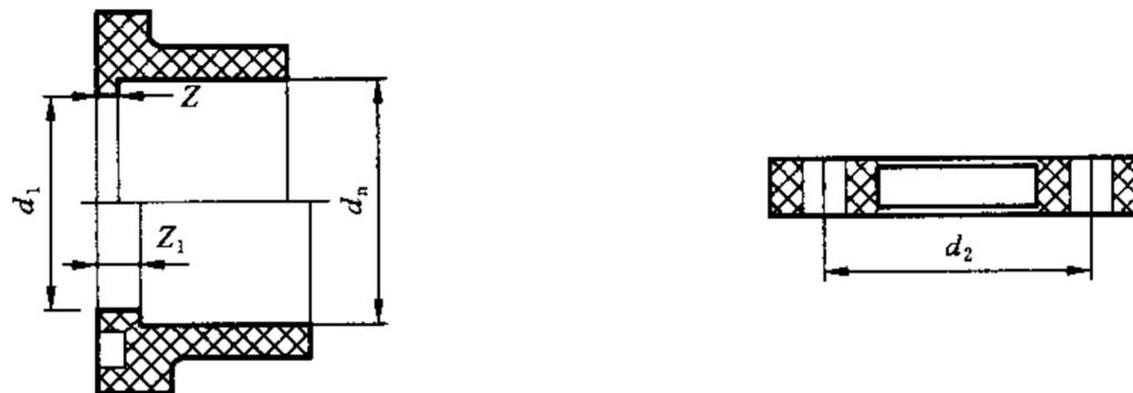
图 A.9 活套法兰变接头
