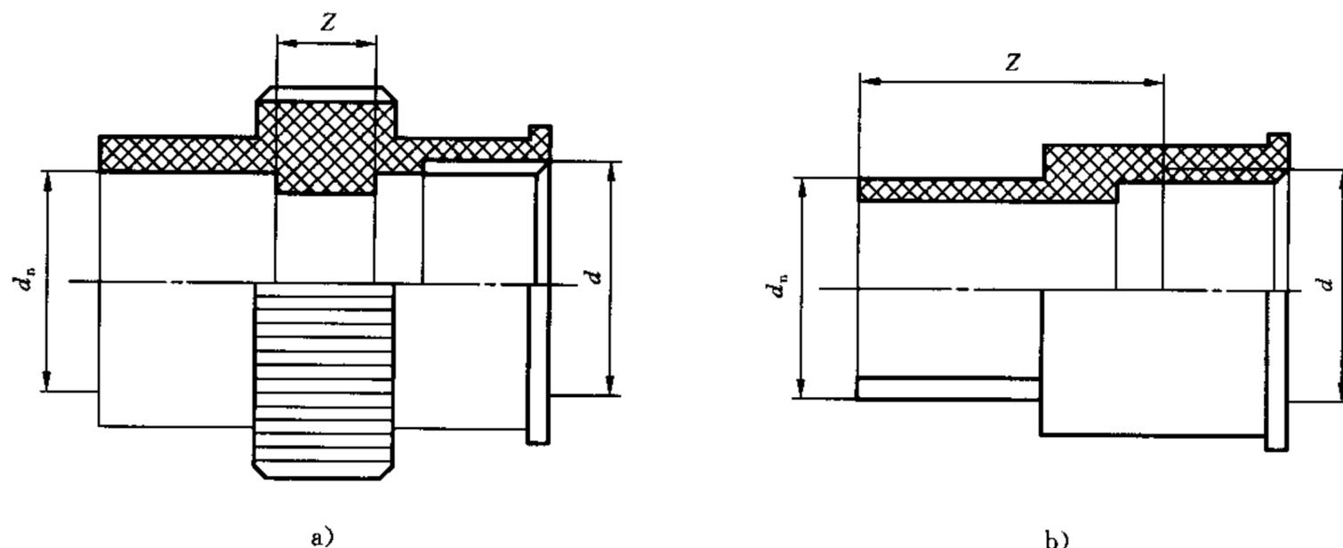
图 A.12 粘结和内螺纹变接头
