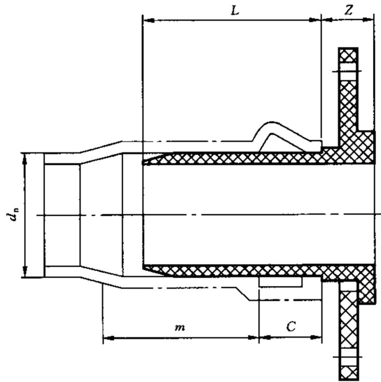
图 A.8 法兰和插口接头
