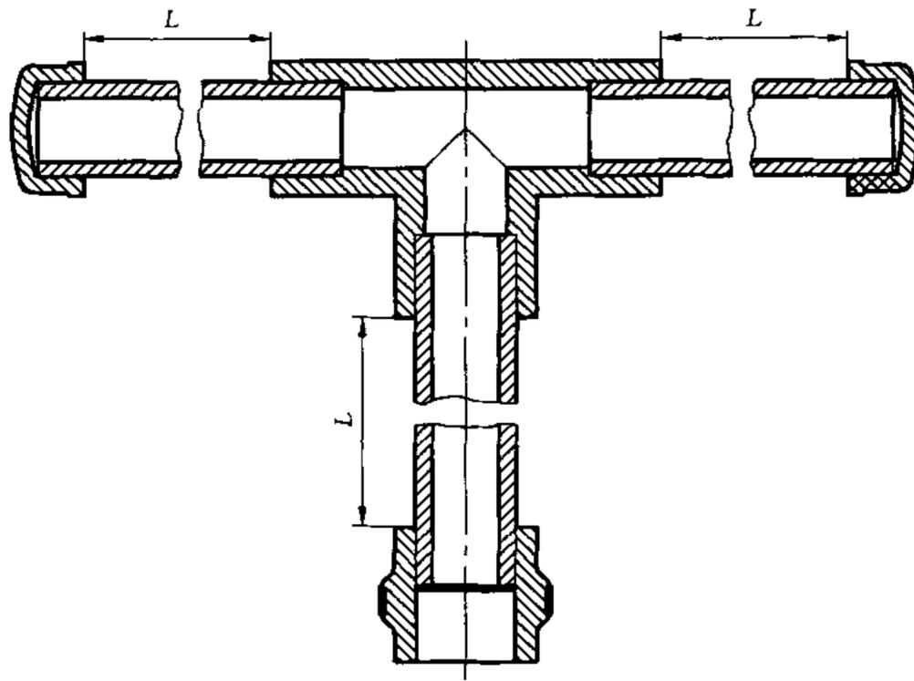
图 B.5 粘接试验组合图
